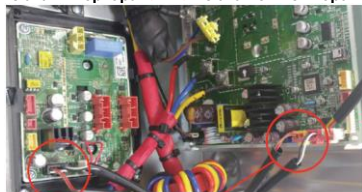
Интерфейсный кабель плата инвертора ↔ плата вентилятора
