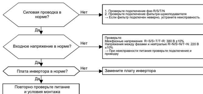
* Измерение входного напряжения
