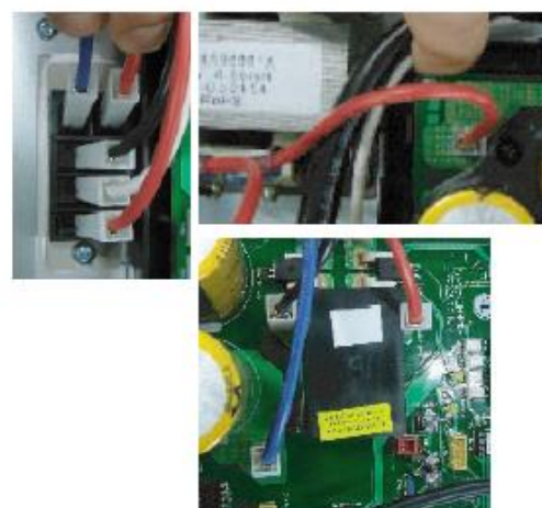
Кабели электропитания платы управления компрессором с инверторным приводом и диодного моста
