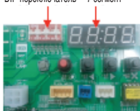
Плата наружного блока
