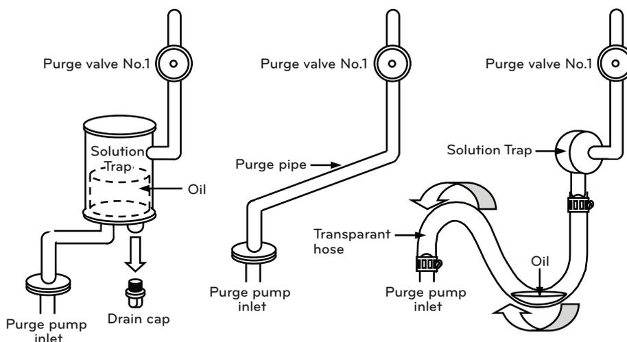
Figure 3-8. Solution trap
