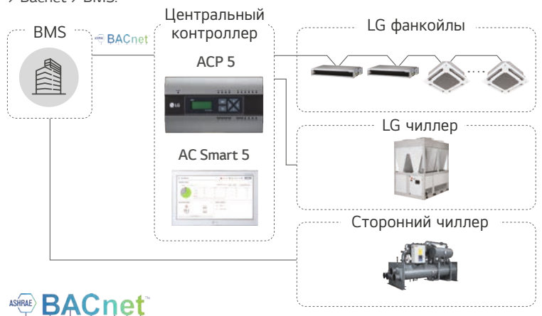
Пример 5. LG фанкойлы + Чиллер (LG или сторонний) > Bacnet > BMS.
