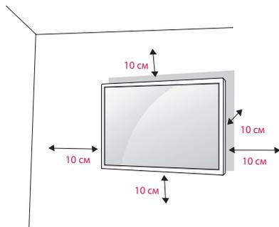
Чтобы установить монитор на стену, прикрепите кронштейн для настенного крепления (дополнительная деталь) к задней части монитора. При установке монитора с помощью кронштейна для настенного крепления надежно закрепите кронштейн, чтобы предотвратить падение монитора.
