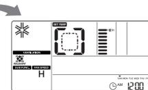
Рис. 2-2. Режим вентиляции
