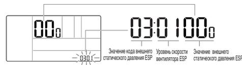
Выберите уровень скорости вентилятора ESP с помощью кнопки . Имеется 5 уровней скорости вентилятора, МЕДЛЕННАЯ → НИЗКАЯ → СРЕД. → ВЫСОКАЯ → МОЩНАЯ.
