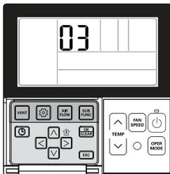
При обнаружении неисправности в системе автоматически выполняется самодиагностика.
