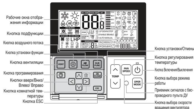
**Рабочие окна отображения информации:** Показывают состояние функционирования и настройки
