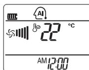
Этой операцией автоматически выбирается режим охлаждения или обогрева в зависимости от температуры помещения.
