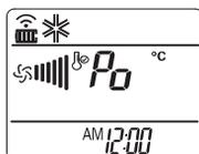
Функция быстрого охлаждения предназначена для охлаждения комнаты жарким летом. Когда функция включена, для быстрого и эффективного охлаждения кондиционер работает в режиме охлаждения со сверхвысокой скоростью вентилятора и установленной температурой 18°C.
