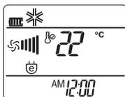
Функция экономного охлаждения позволяет экономить электроэнергию в режиме охлаждения, поскольку она эффективно устанавливает время привыкания к среде в зависимости от изменения времени и температуры и автоматически корректирует необходимую температуру.
