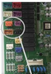
\*\* Проверка вставки катушки 4-ходового клапана до упора
