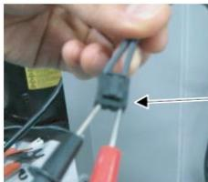
Расположение разъема 4-ходового клапана на главной плате (промаркирован «4way»)
