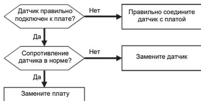
\* Если значение сопротивления датчика температуры изменяется в зависимости от температуры, и текущей температуре соответствуют следующие показания (с погрешностью  $\pm 5\%$ ), то датчик в норме.
