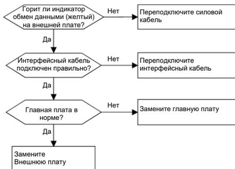
\* Способ проверки главной платы и Внешней платы (в нормальном состоянии будет мигать светодиод обмена данными)
