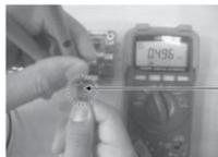
Способ измерения сопротивления датчика температуры
