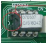
Ключи в гнезде и на корпусе микросхеме ЭППЗУ должны быть обращены в одну сторону.
