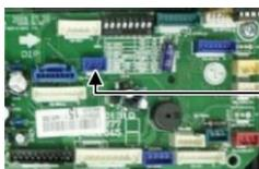
Разъем поплавкового выключателя (CN-FLOAT)
